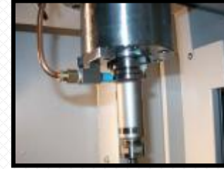
①主轴震摆检测 Spindle seismic pendulum test
