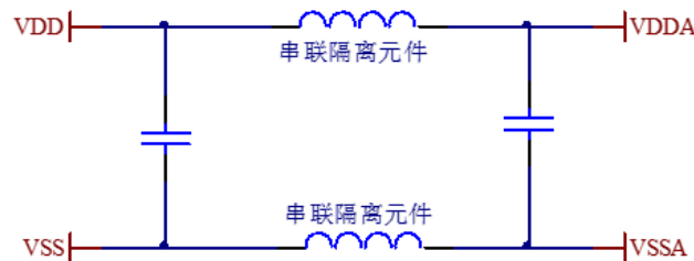
图 93 数字和模拟电源隔离示意图
